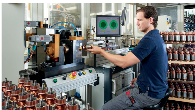
Ankerprüfung in der Wickelei.
