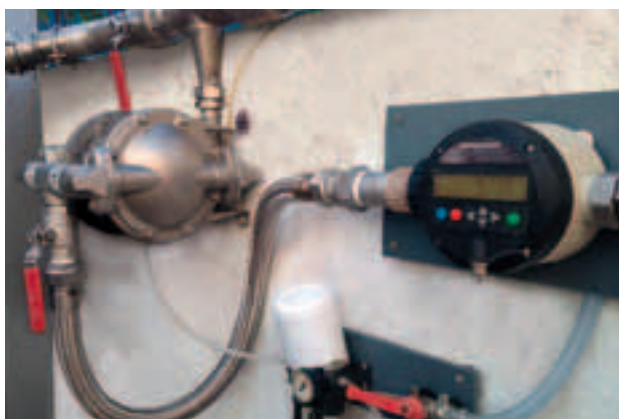
Расходомер FMC 100 и диафрагменный насос в системе с ручным управлением.
