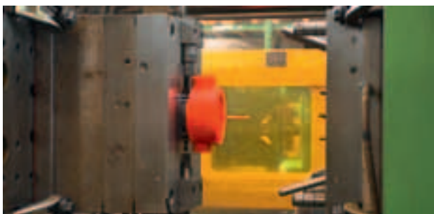
Собственное производство литья под давлением. Здесь изготавливаются корпуса для расходомеров FMC.
