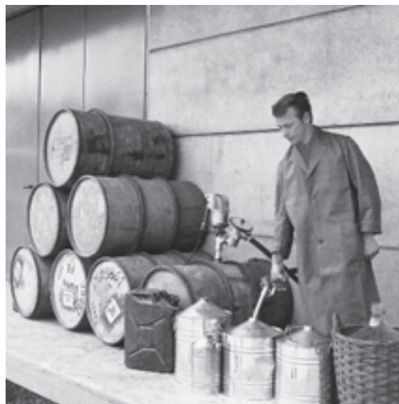
В 1960 году была представлена система заправки с ручным управлением, бочковым насосом и поршневым расходомером.
