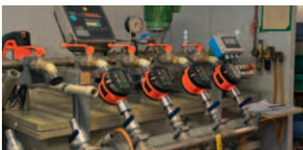
Каждый расходомер проходит тщательную проверку и калибровку. Таким образом осуществляется сплошной контроль качества продукции.
