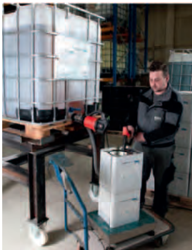
Быстрая перекачка через выпускное отверстие ИВС-контейнера в емкость.
