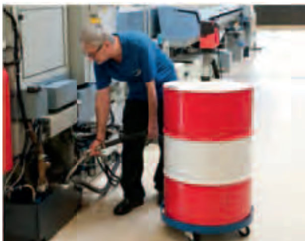
Заправка системы гидравлическим маслом (модель F 430 AL).
