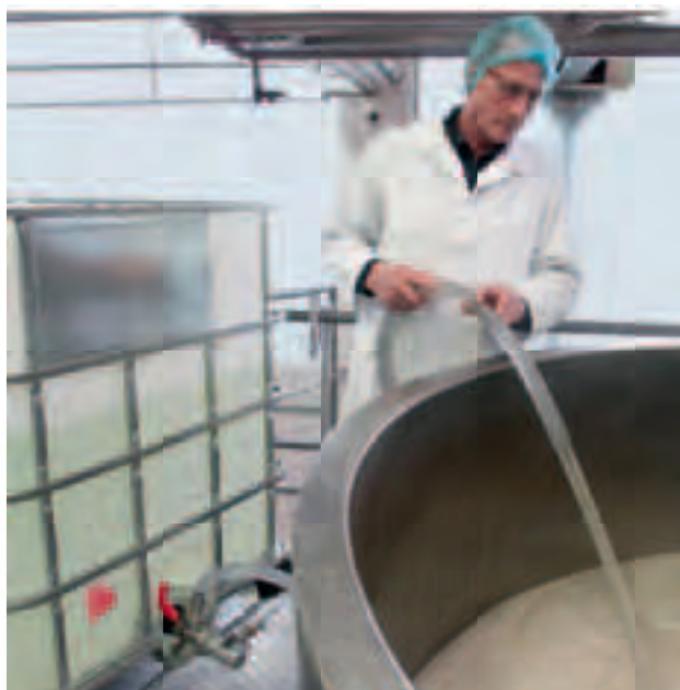
Перекачка из выпускного отверстия ИВС-контейнера в емкость для смешивания.
