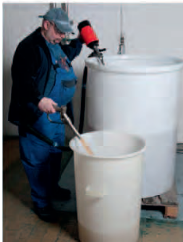
Включение режима перекачки осуществляется простым поворотом рукоятки
