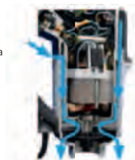
внешняя подача охлаждающего воздуха
