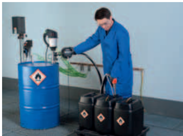
Halbautomatische Kanisterbefüllung in Ex-Zone 1.
