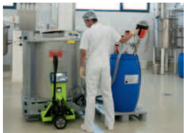
F 560 GS im Hygieneinsatz – Fördern von Cremegrundstoff in ein Mischbehältnis.
