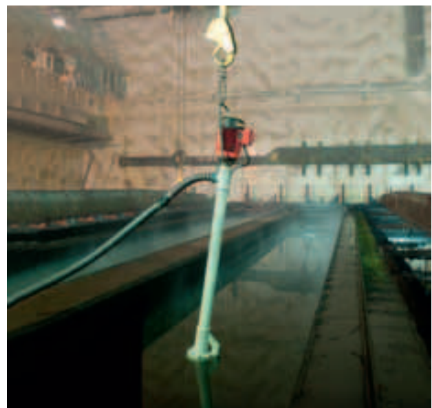
F 640 – Fördern verdünnter Salzsäure aus einem Beizbecken.
