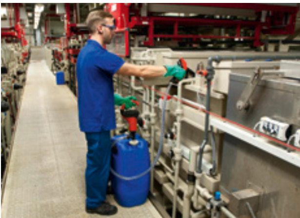
Akku-Motor FBM-B 3100 – die Lösung, wenn Kabelverlegung unerwünscht oder problematisch ist.
