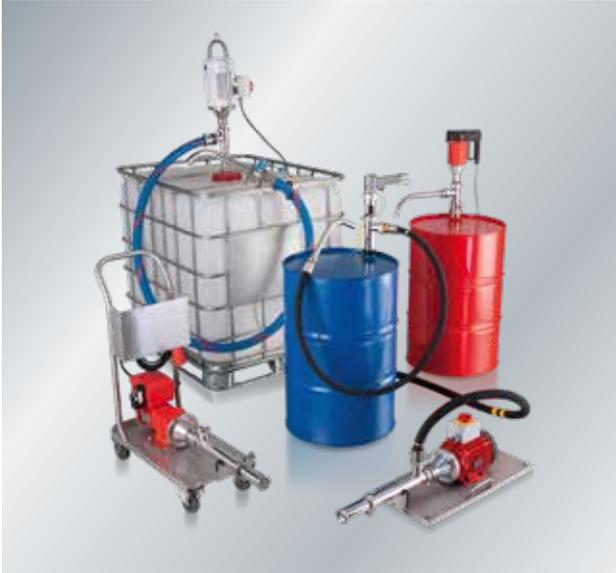
FLUX Exzentrerschneckenpumpen VISCOPOWER eignen sich zur Förderung dünnflüssiger bis viskoser und hochviskoser Fluide. Die Verdrängerpumpen arbeiten turbulenzarm, bei konstantem Druck und sorgen für eine schonende, pulsationsfreie Förderung. Alle VISCOPOWER Exzentrerschneckenpumpen sind mobil und stationär einsetzbar, bestehen aus nur wenigen Bauteilen und sind leicht zerlegbar.
