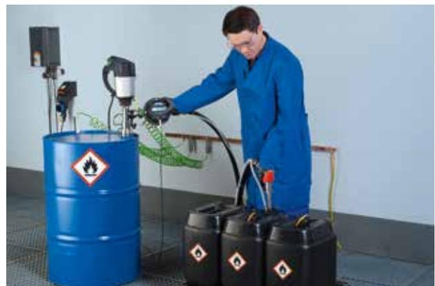
Halbautomatische Kanisterbefüllung in Ex-Zone 1.
