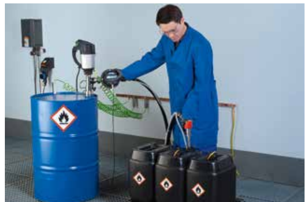
Halbautomatische Kanisterbefüllung in Ex-Zone 1.
