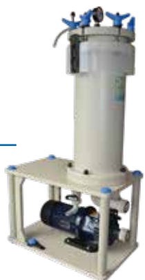
► Filtersystem SONCO (S. 10) z.B. als Kerzenfilter und mit hermetisch dichter MAGSON Magnetkreiselpumpe aus PP zum Filtern eines Zinkbades
