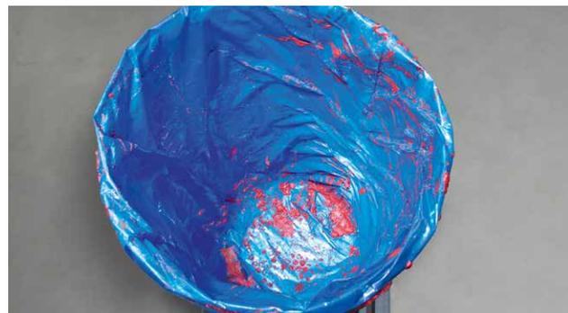
VISCOFLUX mobile S erreicht Restmengen bis unter 1 % auch bei Fässern mit Aseptic Bags.
