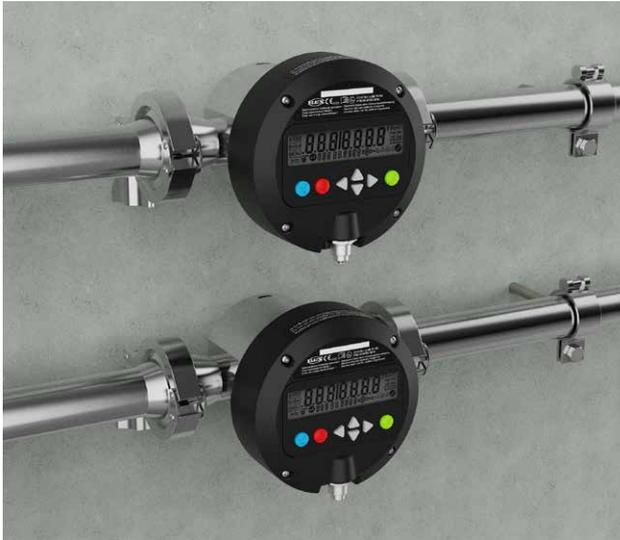
FLUX Durchflussmesser, gebaut nach dem Taumelscheiben- (FMC), Ovalrad- (FMO) oder Turbinenradprinzip (FMT), bieten für jede Anwendung die richtige Lösung. Je nach Modell und Baugröße sind sie z. B. an FLUX Fasspumpen oder stationär z. B. in Rohrleitungssystemen einsetzbar. Mit der Auswerteelektronik FLUXTRONIC® für FMC und FMO können Abfüll- und Dosierprozesse nahezu aller Fluide mit maximaler Präzision und größtmöglicher Sicherheit durchgeführt werden.
