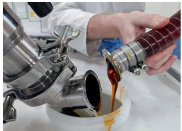
Fördern von viskosem Zuckerrohrsirup in einer Keksfabrik mit der Exzentrerschneckenpumpe VISCOPOWER F 580.
