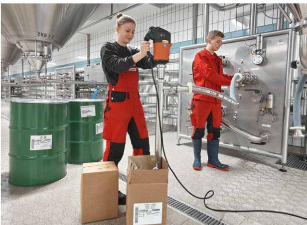
VISCOPOWER F 570 zum Fördern von viskosem Saftkonzentrat.
