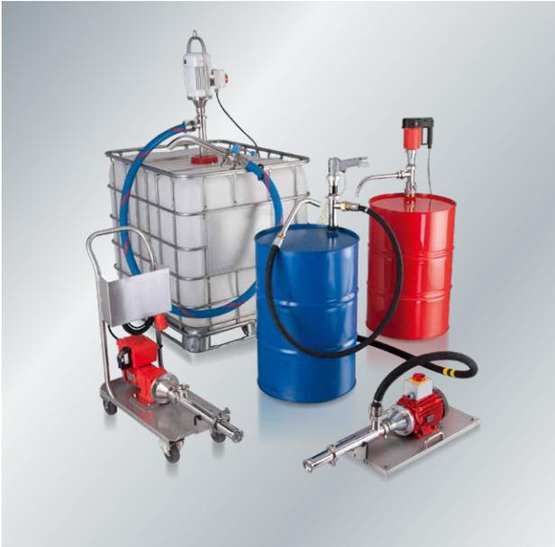
FLUX Exzentrerschneckenpumpen VISCOPOWER eignen sich besonders zur Förderung dünnflüssiger bis viskoser und hochviskoser Fluide. Die Verdrängerpumpen arbeiten turbulenzarm, bei konstantem Druck und sorgen für eine schonende, pulsationsfreie Förderung. Alle VISCOPOWER Exzentrerschneckenpumpen sind sowohl mobil als auch stationär einsetzbar, bestehen aus nur wenigen Bauteilen und sind leicht zerlegbar.
