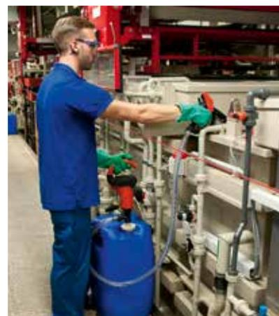
Pumpen-Set mit Akku-Motor – die Lösung, wenn Kabelverlegung unerwünscht oder problematisch ist.
