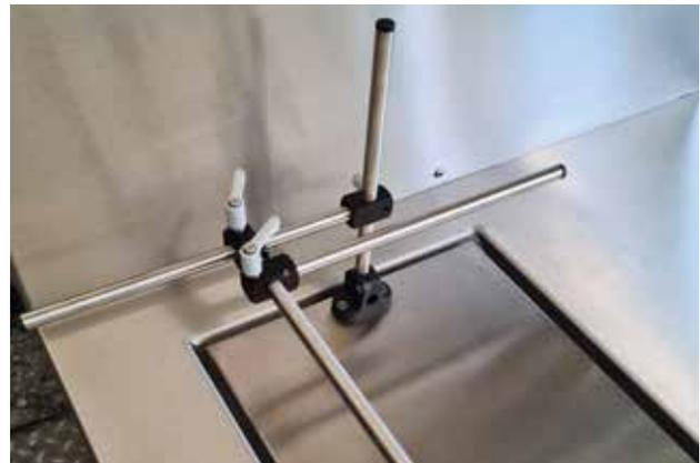
Werkzeuglose Verstellung des Anschlags.
