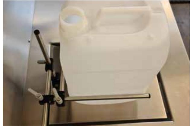
Anschlag zum einfachen Positionieren des Gebindes.
