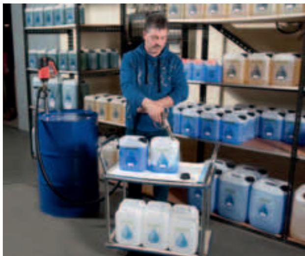
Die Pumpe FP 425 S im Einsatz zum Fördern eines besonders hochwertigen Schmiermittels.
