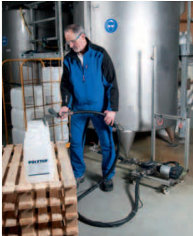
Abfüllen eines Reinigungsmittels aus einem hohen Tank in Kanister.
