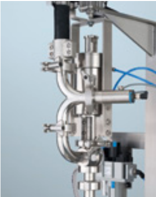
Drucküberwachung zum sicheren Abfüllen hochviskoser Medien (bei Nicht-Ex-Ausführung).
