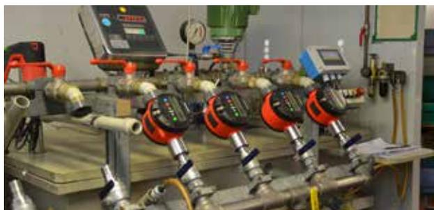
Jeder Durchflussmesser wird überprüft und kalibriert – 100 % Qualitätskontrolle!
