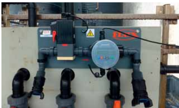
FMC 100 mit Schaltverstärker FSV 100, eingebaut in einer Rohrleitung für eine halbautomatische Abfüllung.
