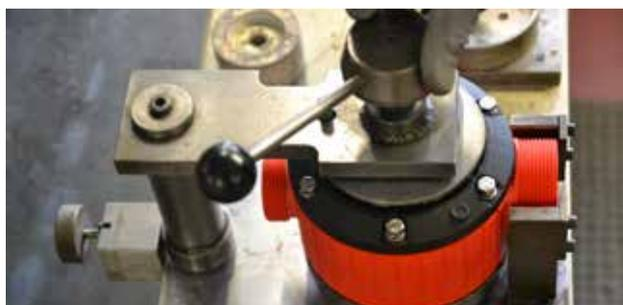
Komplette Montage der Durchflussmesser FMC/FMJ erfolgt im Hause FLUX mit eigens dafür angefertigten Montagevorrichtungen.
