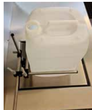
Anschlag zum einfachen Positionieren des Gebindes.
