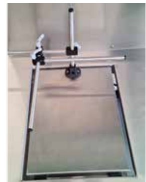
Anschlag zum einfachen Positionieren des Gebindes.
