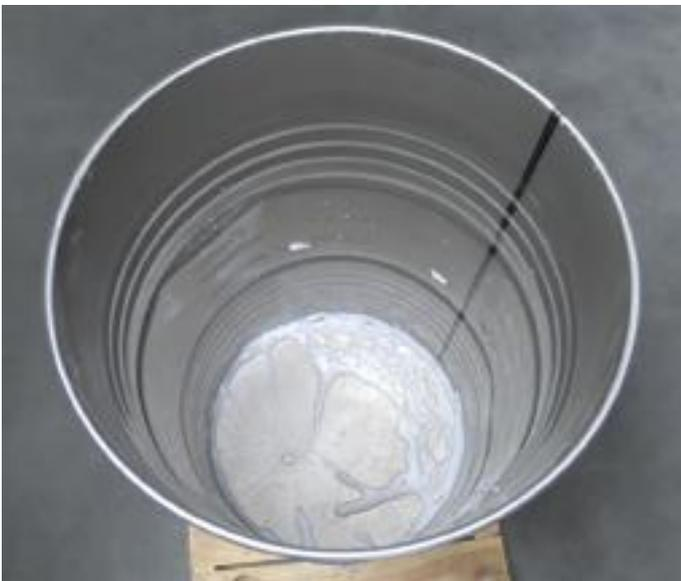
VISCOFLUX mobile – erreicht Restmengen von unter 1 % (bei Fässern ohne Inliner) – auch bei üblichen Transportdellen.
