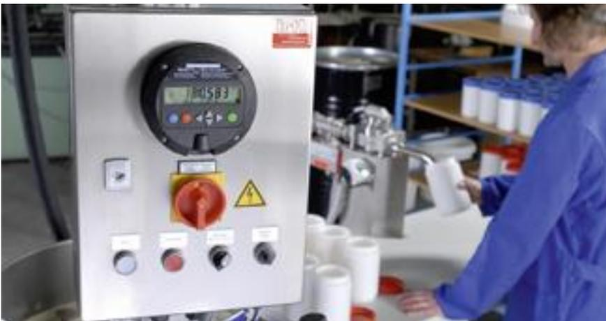
VISCOFLUX mobile – mit Steuereinheit und integrierter FLUXTRONIC® für den Einsatz im Batchbetrieb.
