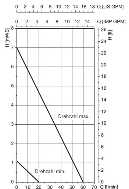
Drehzahl min. 5.000 min<sup>-1</sup>, Drehzahl max. 15.000 min<sup>-1</sup>
