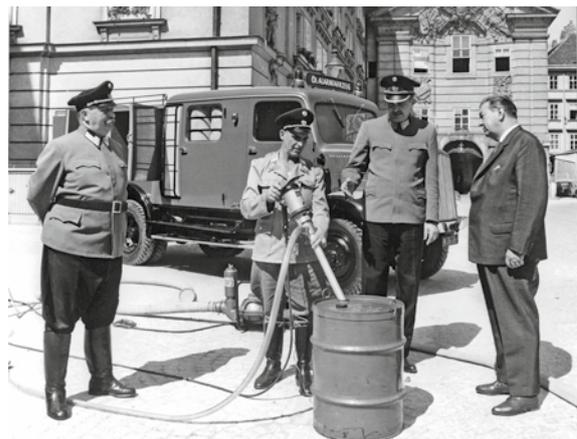
Die weltweit erste elektrische Fasspumpe im Einsatz.
