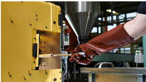
Fertigung des mit Metallkern verstärkten Innenrohrs für Kunststoff-Ausführungen.
